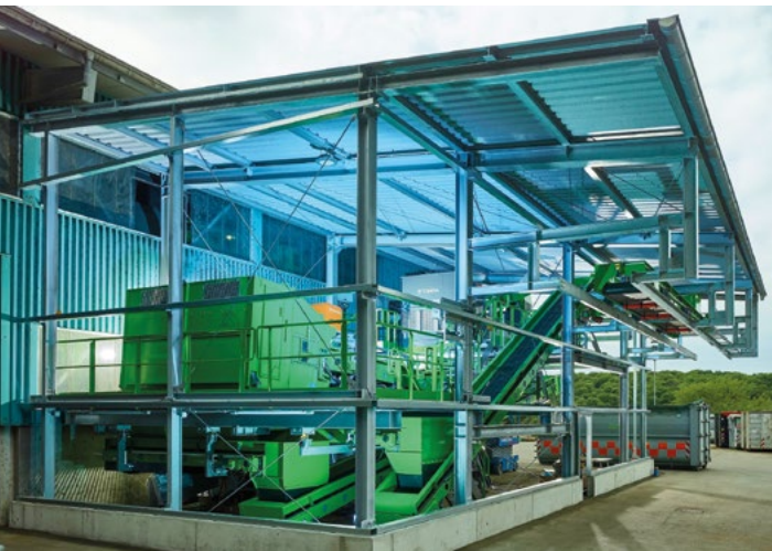
Um Störstoffe im Kompost zu minimieren, setzt die ZAK auf sensorgestützte Sortiertechnologie.
